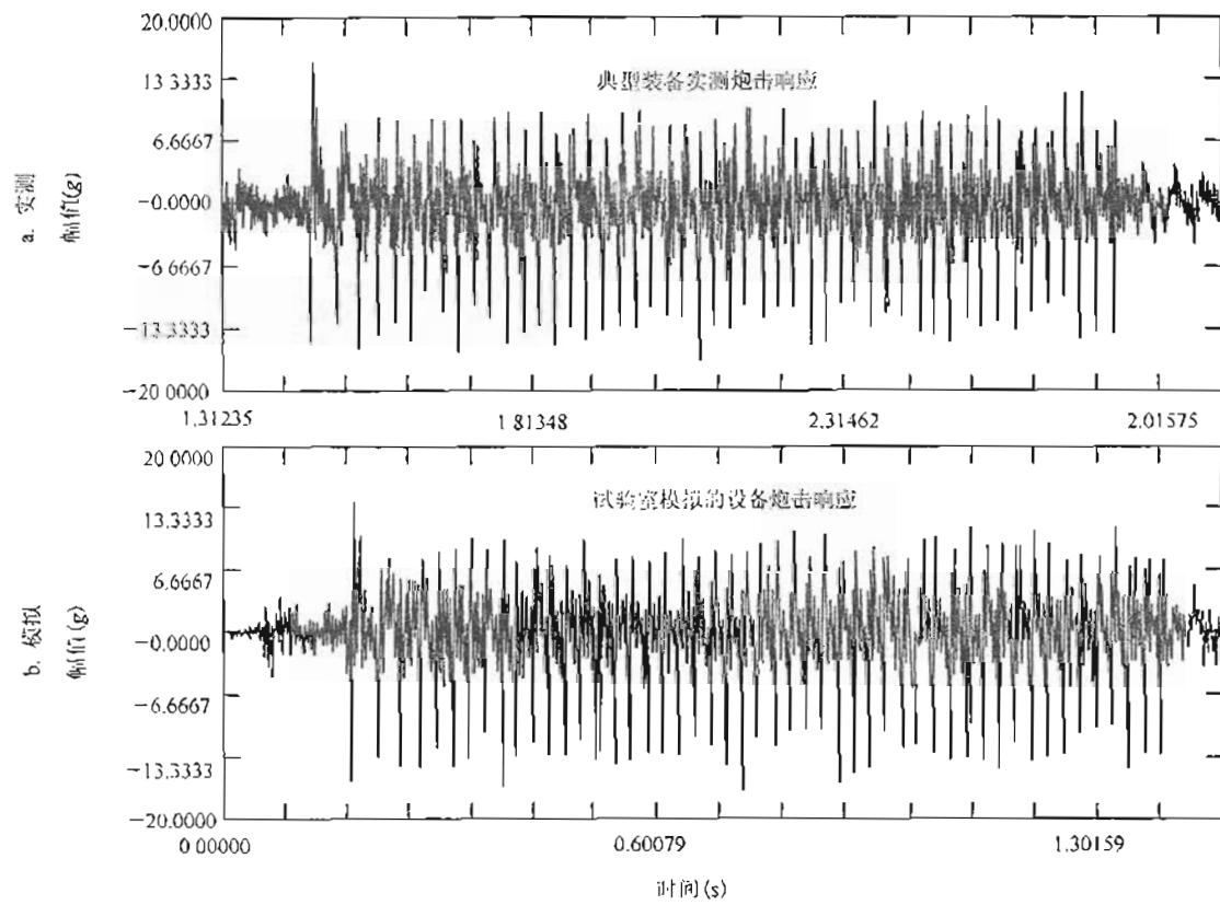
图 A.7 装备实测炮击响应与试验室模拟的装备炮击响应的对比
