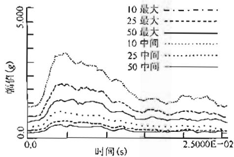
图 B.13 模拟总体样本量为 10、25 和 50 的时变标准差平滑模拟根方差估计
