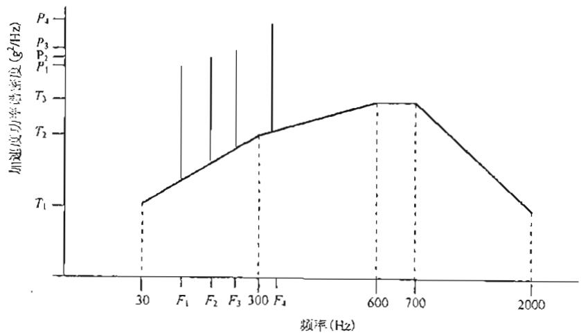
图 D. 1 通用的炮击诱发振动谱
