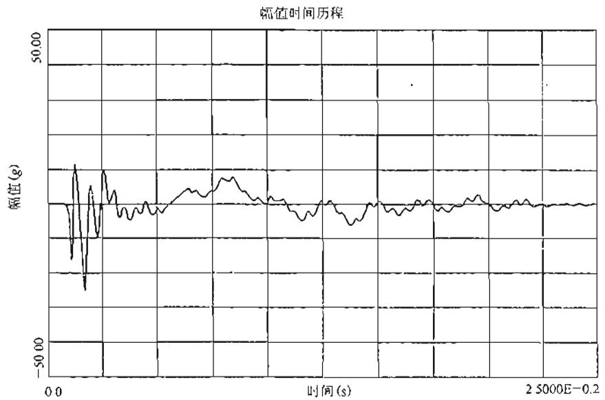
图 C.3 使用数字控制器产生 SRS 炮击脉冲
