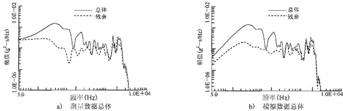
图 B.7 能量谱密度函数估计
