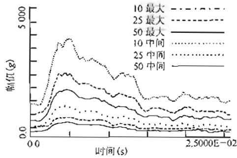
图 B.14 模拟总体样本量为 10、25 和 50 的时变均方根平滑模拟根方差估计
