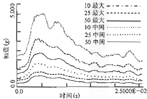
图 B.12 模拟总体样本量为 10、25 和 50 的时变均值平滑模拟根方差估计
