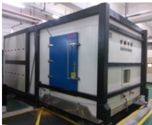
柴油发动机复合式耐候试验箱 Diesel engine composite weathering test chamber 10吨台+10立方 10t+10 m3
