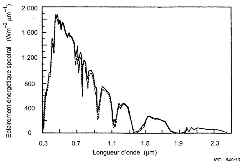
NOTE Profondeur optique de l'extinction de l'aérosol, respectivement de 0,1 (ligne pleine) et 0,27 (pointillés).
